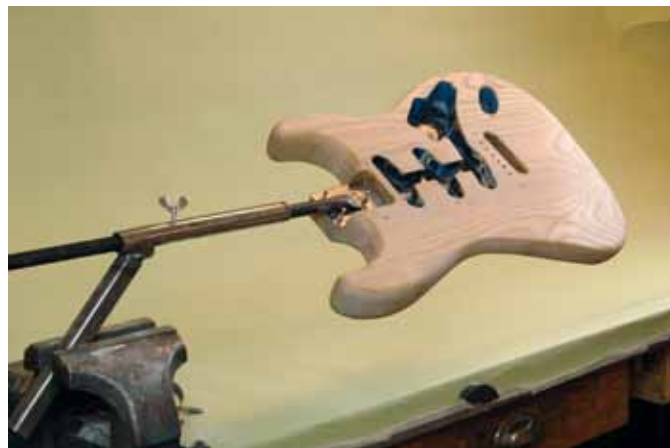
Bild 3: Ett roterbart stativ underlättar arbetet och kan rädda dig från rinningar!
