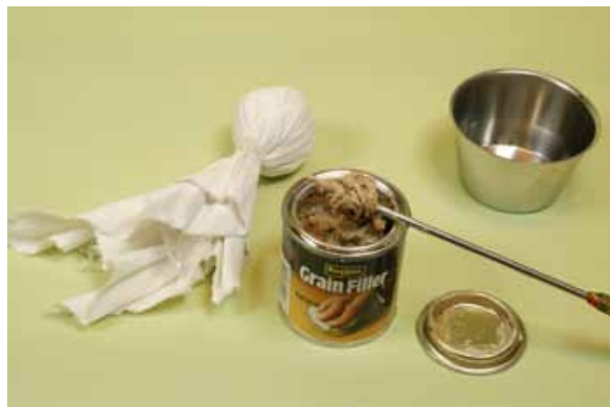
Bild 1: Grova träslag måste porfyllas innan lack. Porfyllaren är trögflytande och måste spädas innan användning. ”Spöket Laban” till vänster används för att gnida in porfyllaren i träet.
