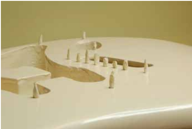
Bild 6: Innan man våt slipar måste alla hål i kroppen täppas till. Lack eller lim är bäst, men man kan även stoppa i "korvar" av maskeringstejp i hålen.
