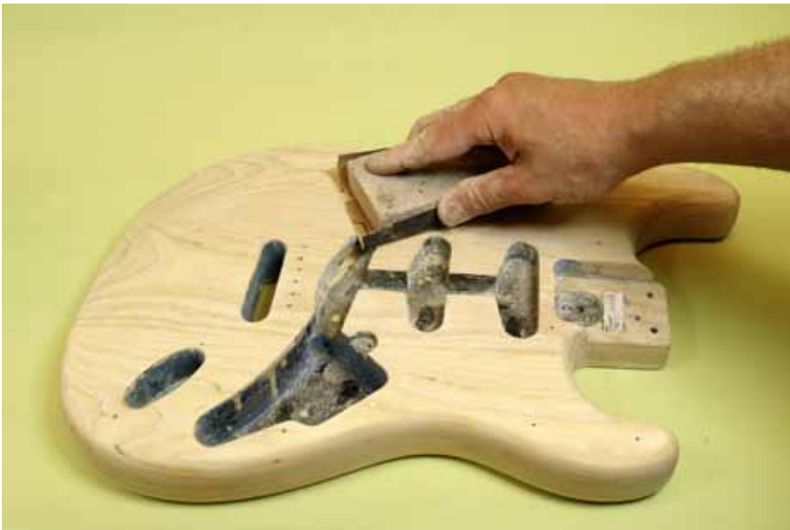
Bild 3: Slipa bort den sista lackhinnan för hand. Använd en kork- eller gummikloss. Nu tar man även till ett finare slippapper på 320 – 400.
