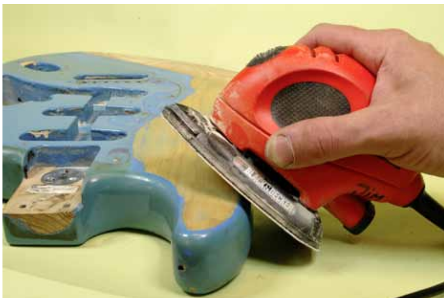
Bild 2: Nä – tänk inte ens tanken! Kör aldrig en slipmaskin mot ett hörn – den lilla kontaktytan gör att den slipar ner på lack och hörn på nolltid. Använd den bara på plana ytor.
