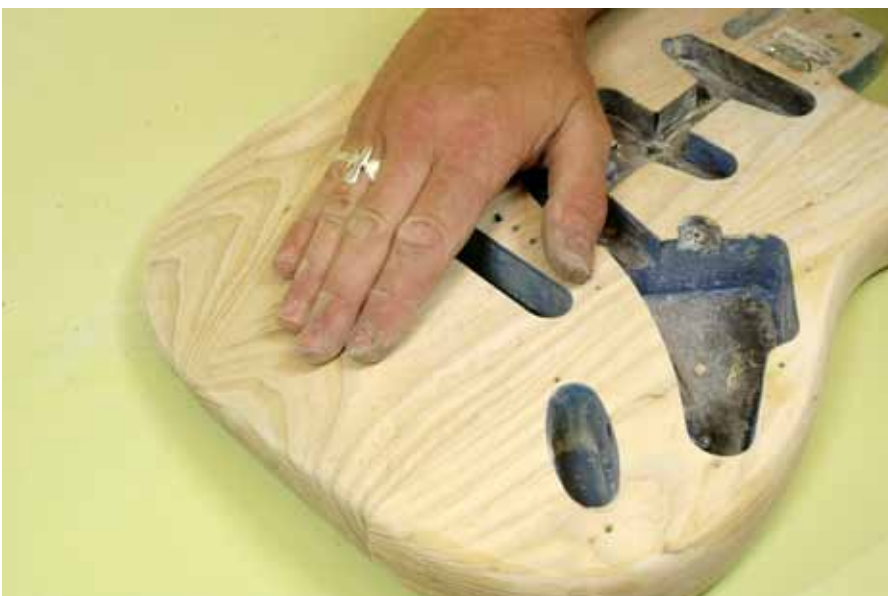
Bild 5: Det är svårt att se repor och ojämnheter på en matt träyta, men med handen kan man känna minsta fel på ytan.
