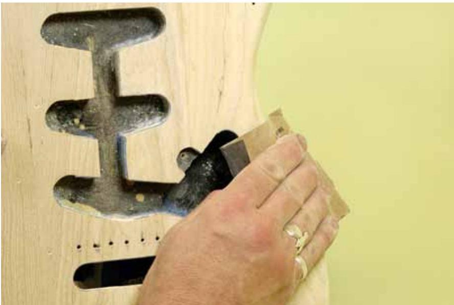
Bild 4: Trots mjuka slipklossar bör man bara använda handen på hörn och kanter.
