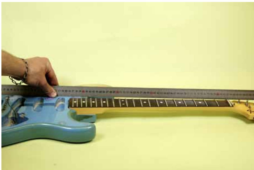
Bild 1: Mät in halsvinkel och andra inställningar innan du tar isär gitarren.
